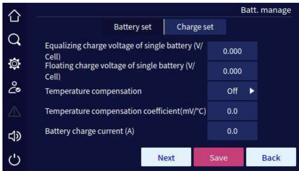
Рис 4.32 Настройка заряда АКБ 1
