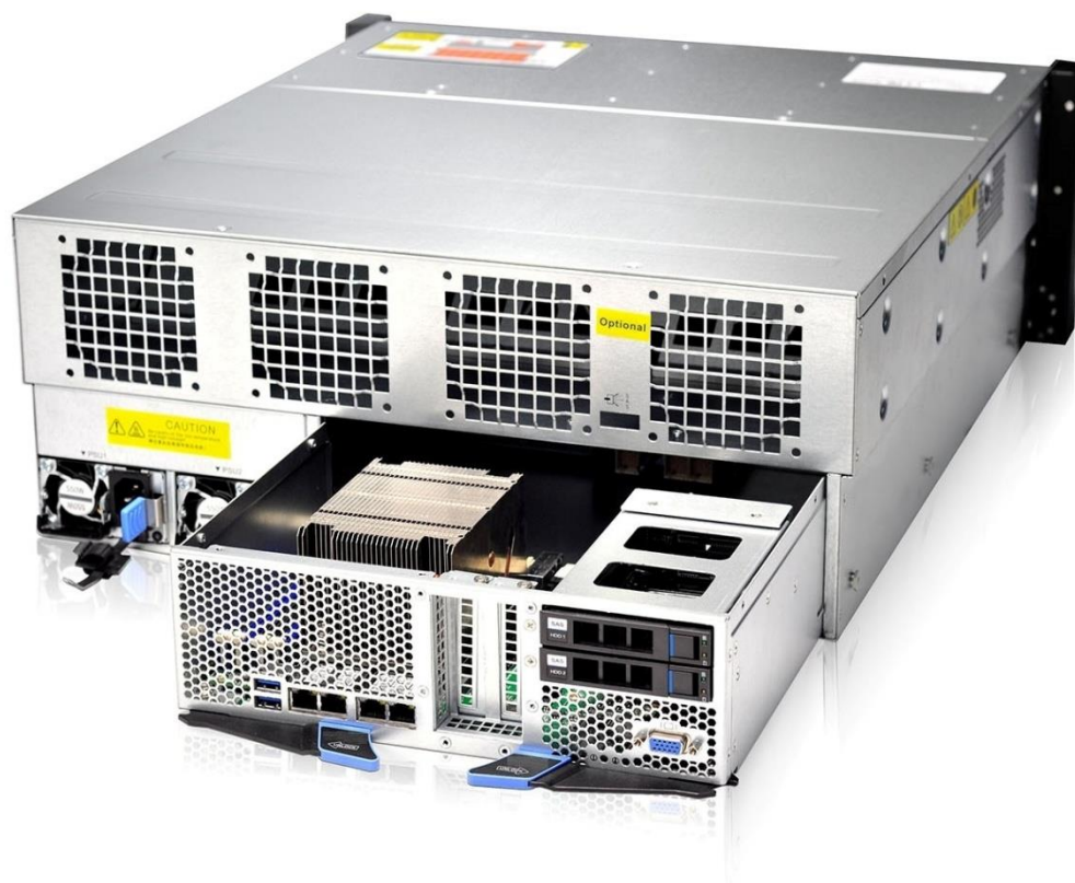
Рис.2 – Серверная платформа QSRV-432404 (вид сверху)
