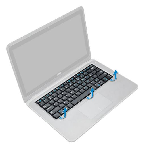
6 Приподнимите клавиатуру и вытащите ее из компьютера.
