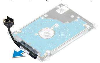
5 Затем выверните винты M3xL3, чтобы отсоединить металлический кронштейн от жесткого диска [1].
