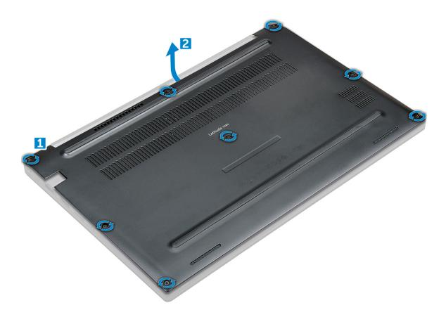
3 Снимите заднюю крышку с компьютера.
