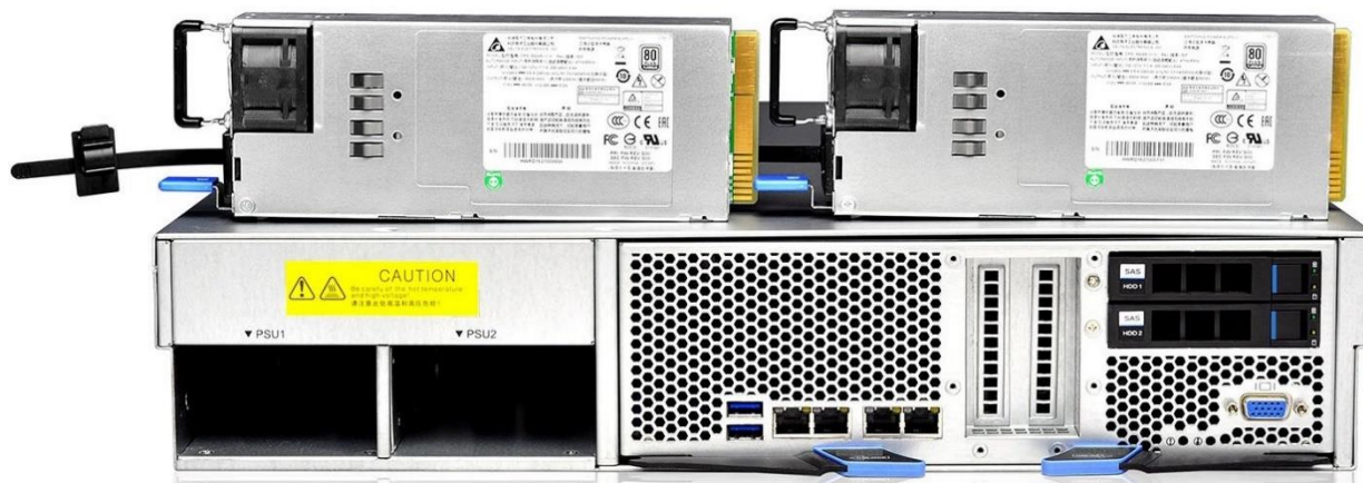
Рис.1 – Сервер видеонаблюдения QSRV-VS-231204 (Вид сзади)
