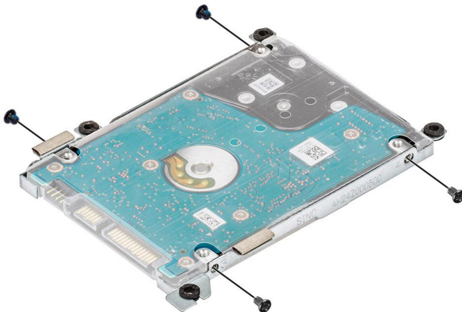
6 Поднимите кронштейн, чтобы снять его с жесткого диска.
