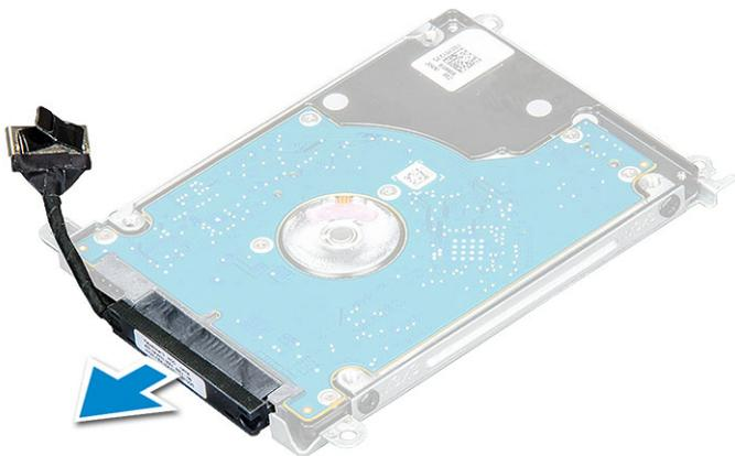
5 Затем выверните винты М3х3, чтобы отсоединить кронштейн от жесткого диска.
