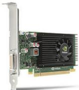
Эффективная производительность двух дисплеев в низкопрофильной графической карте PCI Express благодаря графической карте NVIDIA NVS 315 PCIe x16 1 Гб — идеальное решение приложений для профессионального и коммерческого использования.
