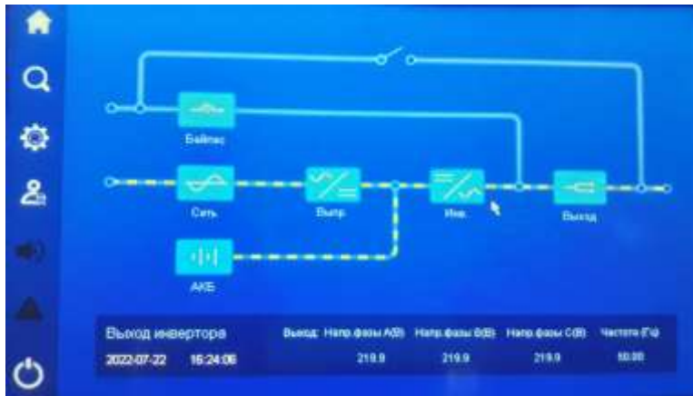
Рис 4.7 Сеть в допуске, инвертор питает нагрузку
