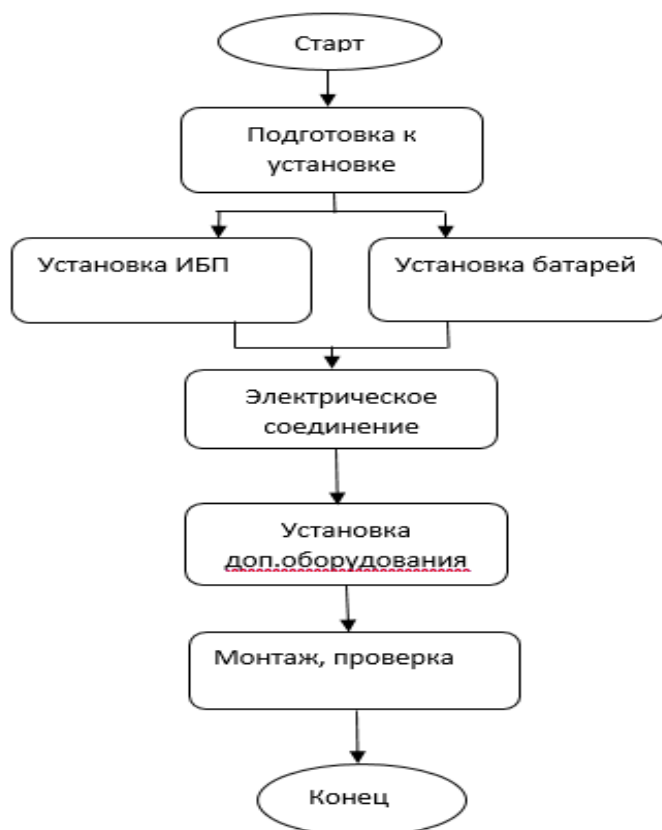
Рис3-1 Алгоритм установки ИБП
