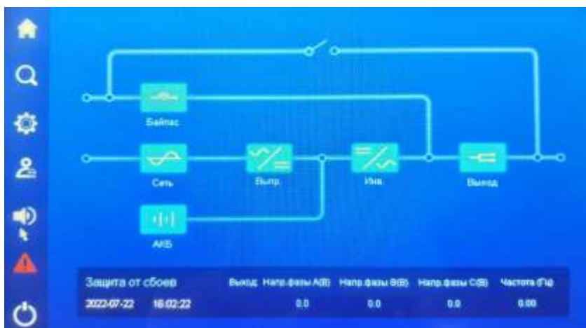
Рис 4.12 Срабатывание аварийной защиты. Нагрузка без питания
