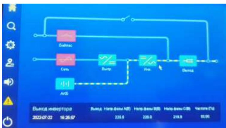
Рис 4.6 Работа от АКБ
