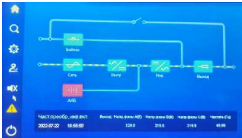
Рис 4.10 Работа ИБП в режиме преобразователя частоты
