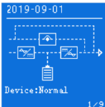
Рис.4-3. Главная страница ЖК-дисплея. Мнемосхема ИБП.
