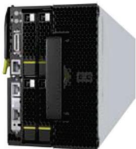
Серверный узел XH622 V3 полной высоты с двумя сокетами занимает два слота в сервере X6800. В нем используются процессоры Intel® Xeon® серии E5-2600 v3, имеется 16 слотов памяти DDR4 и два 2,5-дюймовых SSD или HDD SAS/SATA. XH622 V3 поддерживает до двух двухслотовых GPGPU или плат Xeon-Phi. Серверные узлы XH622 V3 могут применяться в решении Huawei ES3000, предназначенном для ускорения работы хранилищ данных, а также для поддержки высокопроизводительных вычислений, обработки графики и онлайн-игр.
