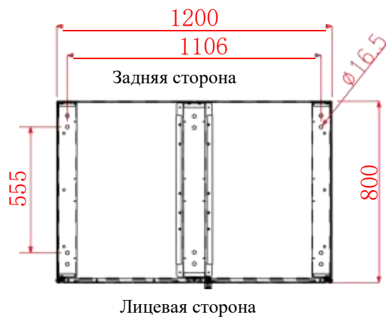
Рис 3.23 Размер батарейного шкафа для АБ-ФР-УКДЛЗ1 (10~60 кВА)
