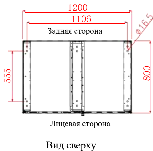
Рис 3.26 Габариты шкафа байпаса для АБ-ФР-УКДЛЗ1 (80-120 кВА)
