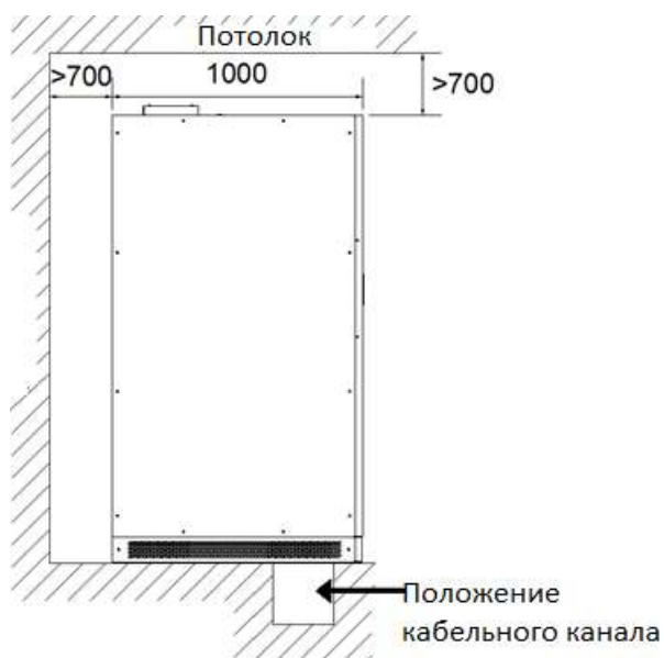
Рис 3.2 Необходимое расстояние при установке АБ-ФР-УКДЛЗ1 (10~120кВА)
