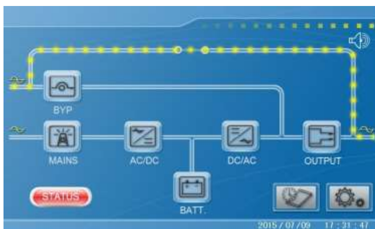
Рис 4.12 Работа через сервисный байпас
