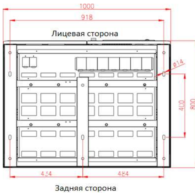
Рис 3.9 Вид снизу АБ-ФР-УКДЛЗ1 (40~60кВА)
