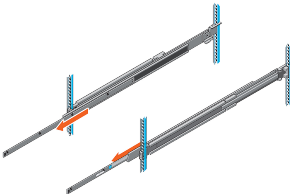
Рисунок 25. Вытягивание внутренней направляющей
