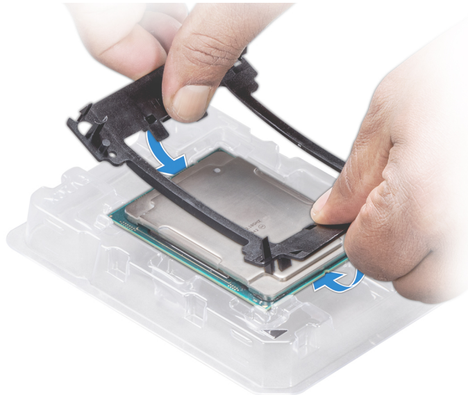
Рисунок 14. Установка консоли процессора
